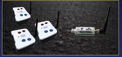
Un receptor inalámbrico está conectado a la computadora de puntuación y recibe señales del hogus y los joysticks inalámbricos (jueces). Cuando recibe una señal, la decodifica y la envía al software TrueScore.
